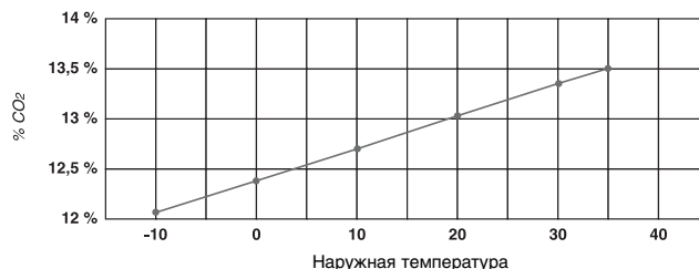
Рис. 20: Диаграмма выбросов CO 2 для горелки BM 1 LN 1
