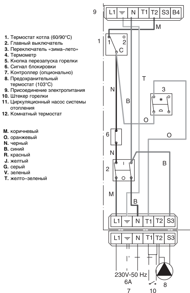
Рис. 7: Электрическая схема для моделей F и FV
