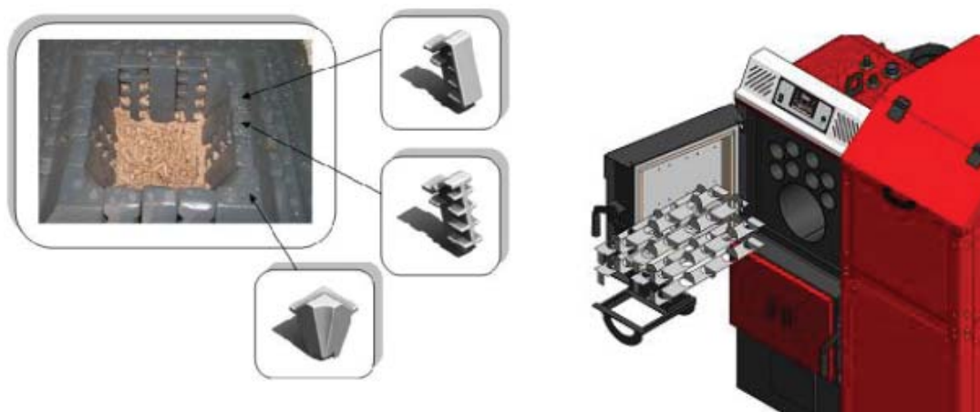
Извлечение турбулизаторов из котла ECO COMFORT
