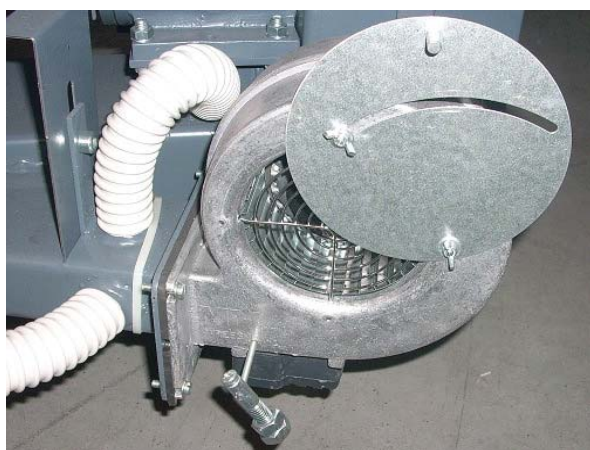
Положение макс. открытой воздушной заслонки вентилятора
