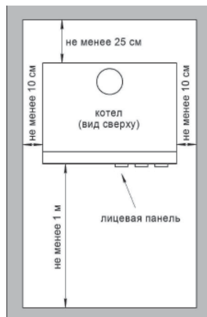
Рис. 5 – Схема установки котла
