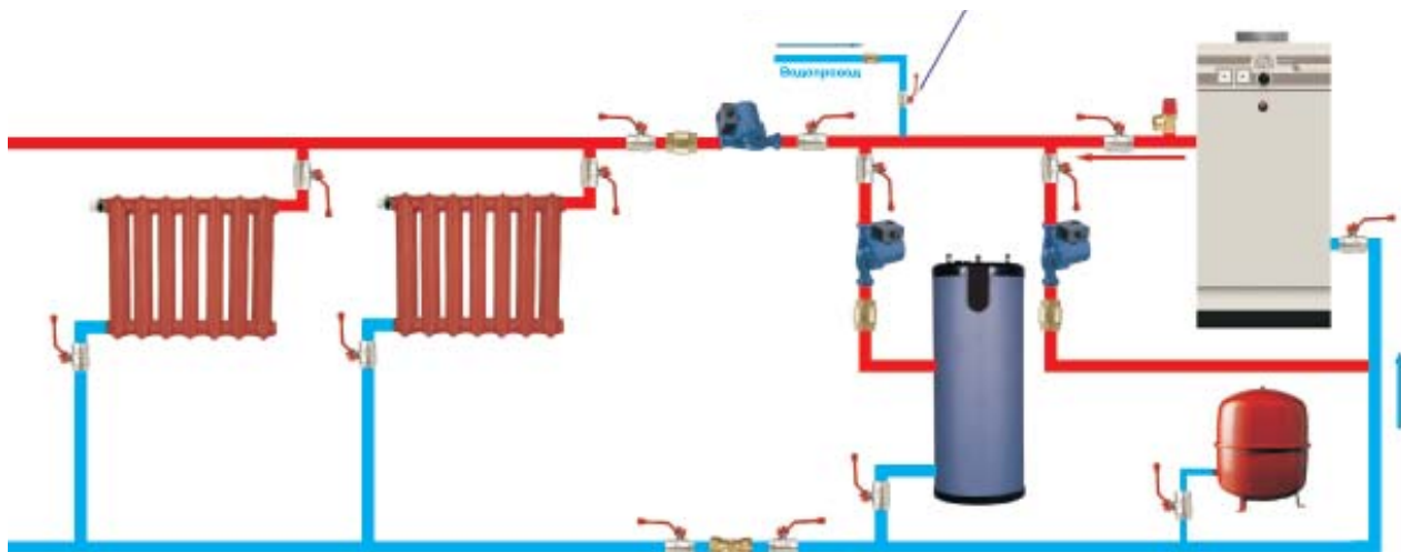
Рисунок 7. Схема подключения котла с принудительной циркуляцией теплоносителя.
