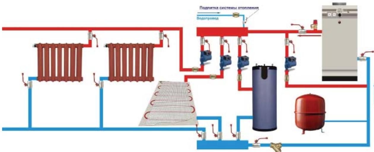
Рисунок 6. Схема подключения котла с общим коллектором.
