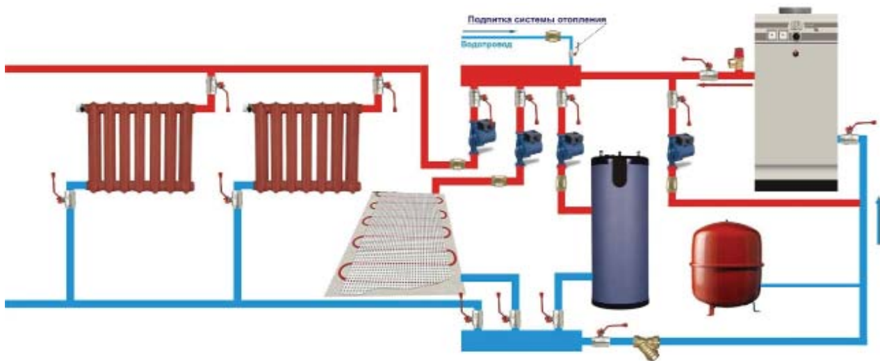
Рисунок 6. Схема подключения котла с общим коллектором.
