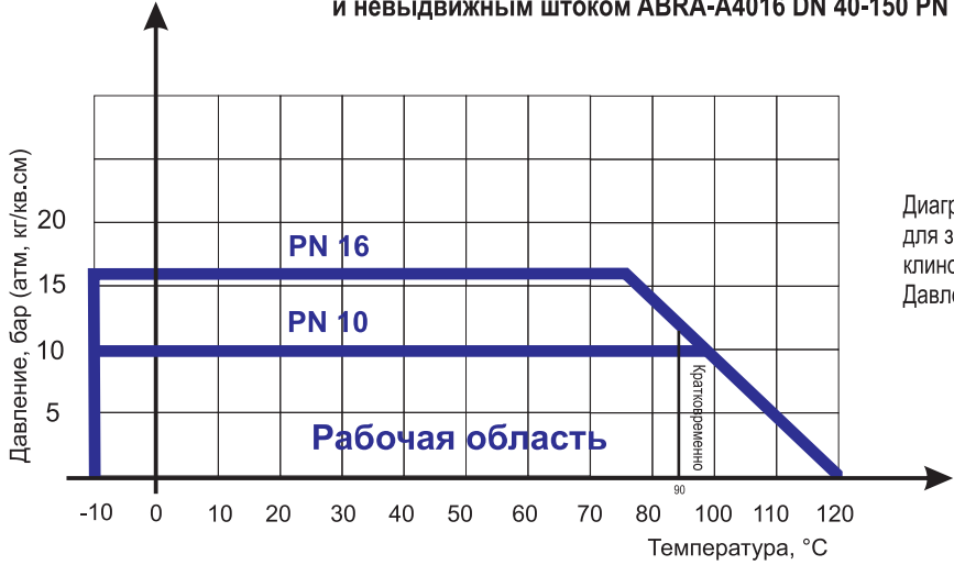
Диаграмма Давление / Температура для задвижки клиновой с обрезиненным клином и неподвижным штоком ABRA-A4016 DN 40-150 PN 10/16, DN 200-600 PN 10/16:
