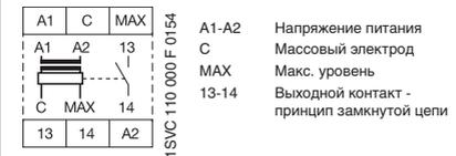
При использовании металлического резервуара от массового электрода С можно отказаться, присоединив кабель непосредственно к металлической поверхности резервуара.
