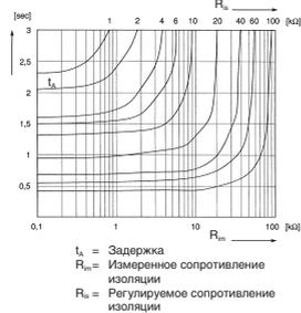
Прибор **CM-IWN-AC** применяется для контроля сопротивления изоляции одно- или трехфазных сетей переменного тока. Основная область применения - контроль вторичных цепей, электрически изолированных от земли. CM-IWN-AC контролирует сопротивление изоляции между незаземленными сетями переменного тока и защитным заземляющим проводом. Измерение производится с помощью наложенного измерительного напряжения постоянного тока.
