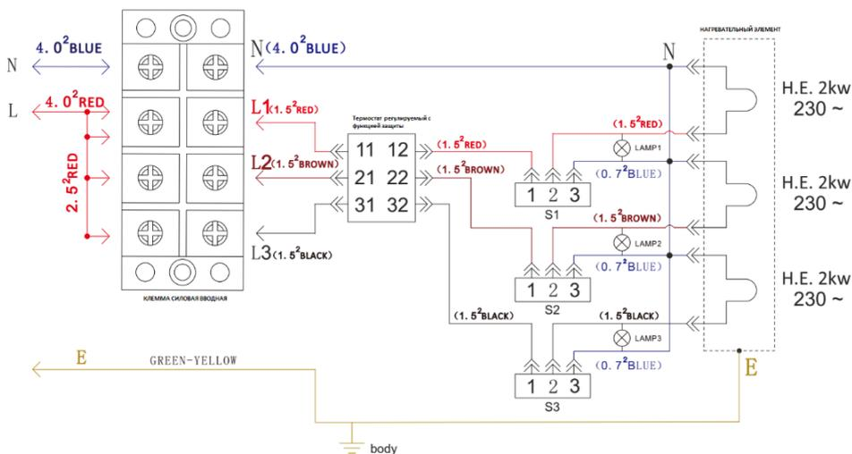
Рис.3 Электрическая схема однофазного подключения
