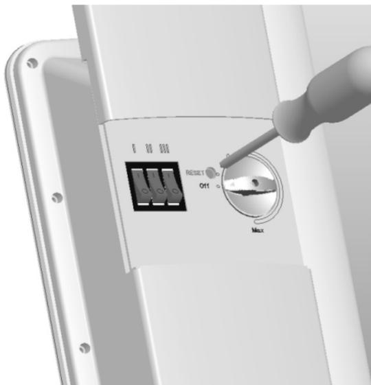
**Рис.7 Перезапуск термopедохранителя**
