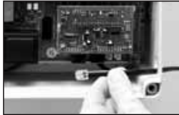
Коммуникационный провод протяните через изолятор
