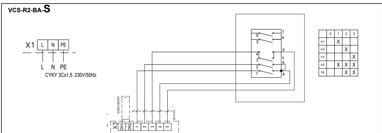
\*Минимальное рекомендуемое сечение кабеля для подключения устройства управления 6x0,5 мм<sup>2</sup>
