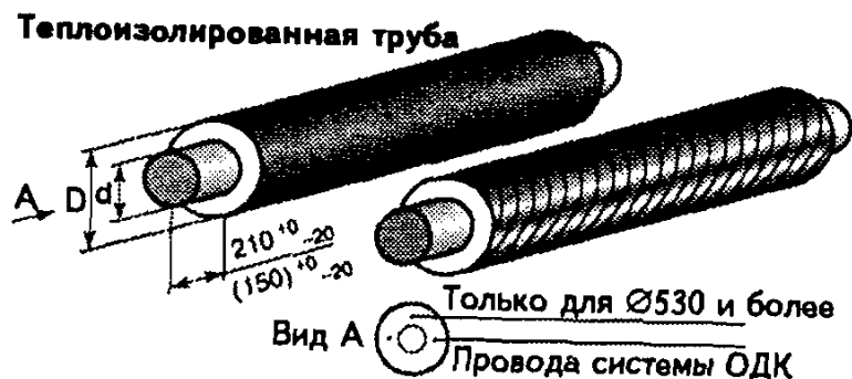
Рис. 6.31. Теплоизолированные ППУ трубы для бесканальной (в полиэтиленовой оболочке) и надземной прокладки тепловых сетей (в металлической оболочке)
