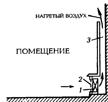
рис. 4.11. Схема рециркуляционного воздухонагревателя: 1 - калорифер; 2 - декоративная решетка; 3 - канал для нагретого воздуха
