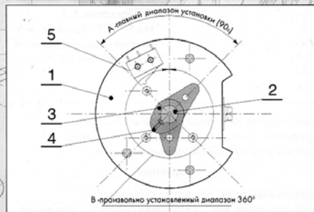
Рис. 1 - Система размещения кулачков и микровыключателей
