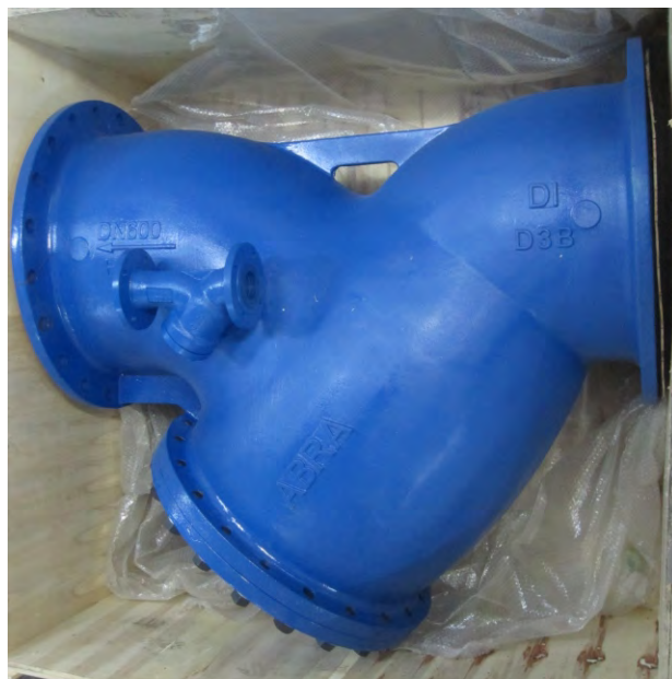
На фото фильтр DN 600, сверху лежит DN 65
