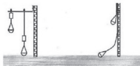
Рис. 26 Монтаж поплавкового выключателя MS2 M2
