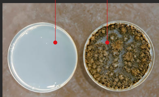
Сравнение роста бактерий и плесени на поверхностях вентилятора (микроскопическое изображение)
