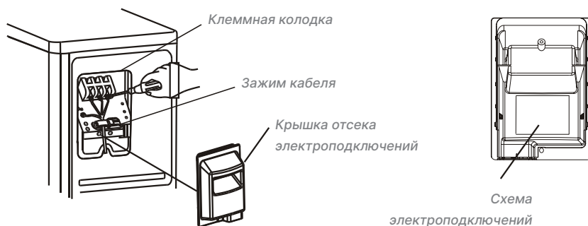
Рисунок 18 — Расположение клеммной колодки во внешнем блоке
