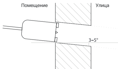
Рисунок 5 — Угол наклона отверстия в стене при бурении
