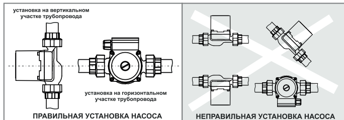
Рис.3 Установка циркуляционного насоса
