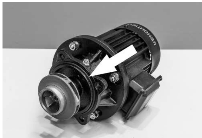
Демонтируйте кольцевое уплотнение (O-ring)
