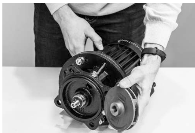
Демонтируйте рабочее колесо
