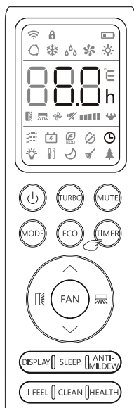
Рисунок 1. Задание включения по таймеру при выключенном кондиционере
