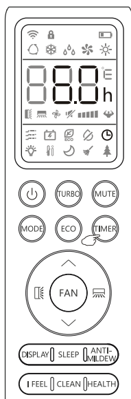
Рисунок 2. Задание выключения по таймеру при включенном кондиционере
