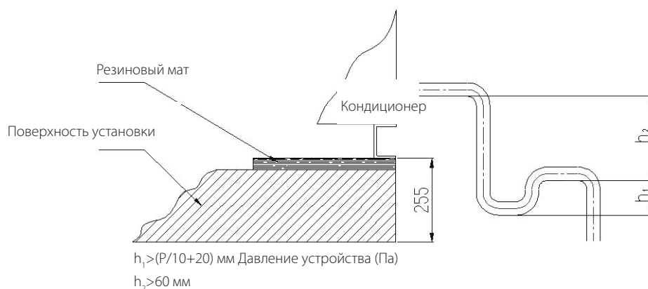
Схема U-образного изгиба дренажного трубопровода
