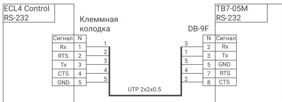
Рис.23. Схема подключения тепловычислителя TB7 к ECL4 Control 368R ПЧ Ethernet/Cloud.
