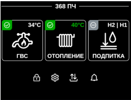
Рис.7. Пример изображения трех модулей автоматики с разными статусами – в аварии, в работе и остановлен. У каждого модуля автоматики есть своя характерная иконка с динамическим отображением ключевых показателей работы соответствующей системы. В левом верхнем углу отображается текущий статус модуля, который может принимать три значения – модуль остановлен (серая иконка), модуль в работе (зеленая иконка) и на модуле есть авария (красная мигающая иконка), Рис.7. Описание отображаемой на иконках разных модулей информации приводится в Табл.5.
