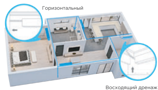
Стандартная схема воздушного потока при обогреве
