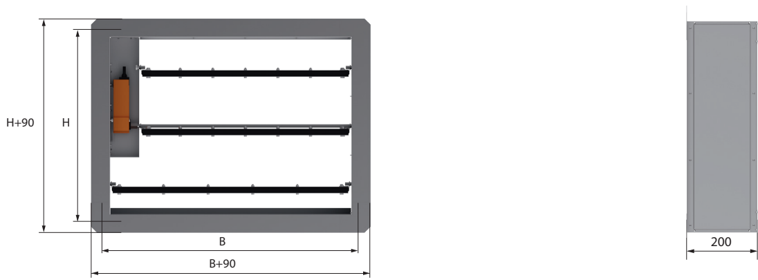
Габариты (мм) и масса (кг) клапанов UVSWL EI 90
