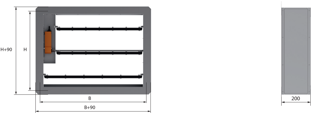
Габариты (мм) и масса (кг) клапанов UVSWL EI 120
