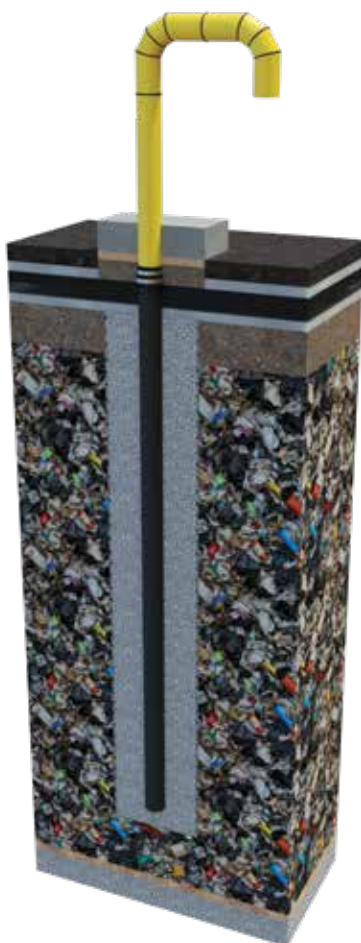
Пример обустройства скважины для пассивной дегазации
