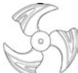
Лопasti, разработанные Midea, с высоким статическим давлением
