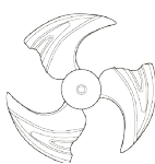
Лопasti с высоким статическим давлением
