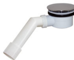
ДХ-912 сифон для душ. поддона 1 1/2" x 90, высота h= 65 мм
