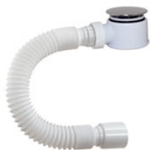
ДХ-512 сифон для душ. поддона 1 1/2" x 50, высота h= 78 мм
