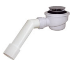
ДХ-513 сифон для душ. поддона 1 1/2" x 50, высота h= 78 мм
