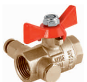
КРАН ШАРОВОЙ С ДРЕНАЖЕМ И ВОЗДУХООТВОДЧИКОМ ДЛЯ ВОДЫ, РУЧКА-БАБОЧКА, ВР-M20x1,5 N/P59
