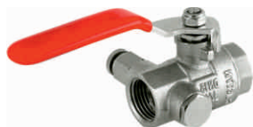
КРАН ШАРОВОЙ С ДРЕНАЖЕМ И ВОЗДУХООТВОДЧИКОМ ДЛЯ ВОДЫ, НИКЕЛИРОВАННЫЙ, РУЧКА-РЫЧАГ, ВР-М20х1,5 N/P59
