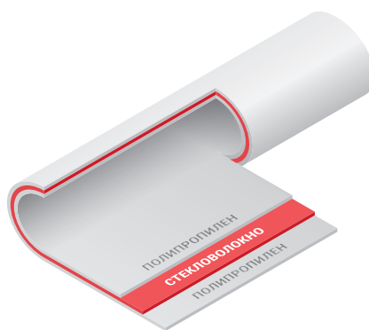
Полипропиленовая труба армированная стекловолокном
