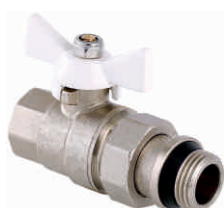
КРАН ШАРОВОЙ ПРЯМОЙ СО ШТУЦЕРОМ И ДОП. УПЛОТНЕНИЕМ, НИКЕЛИРОВАННЫЙ, РУЧКА-БАБОЧКА, ВР-ВР N/P59
