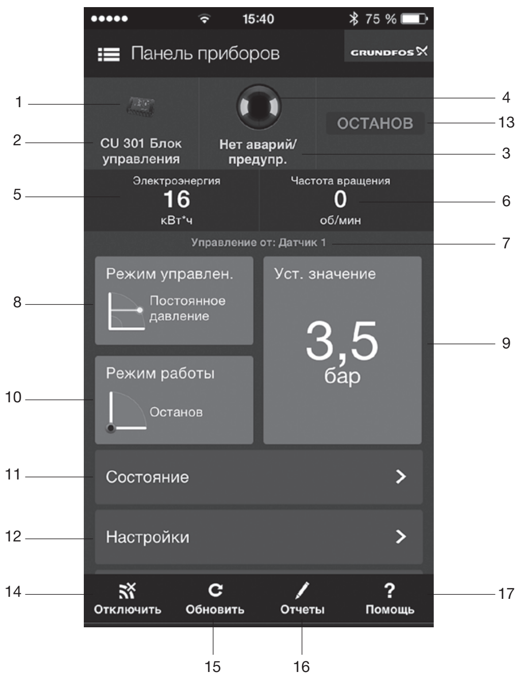
Рис. 25 Устройство беспроводного управления Grundfos GO Remote
