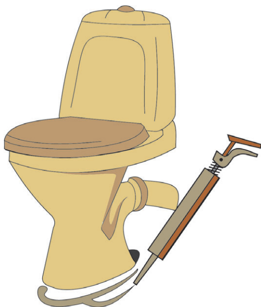
Рис. 7.14. Крепление унитаза на клей
