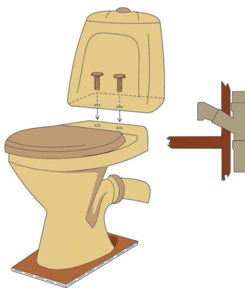
Рис. 7.15. Подсоединение бачка к полке унитаза
