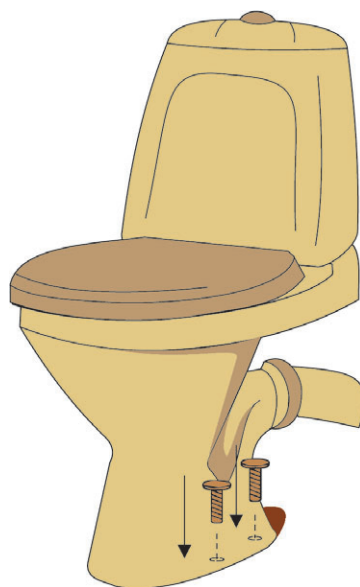
Рис. 7.12. Крепление унитаза на шурупы
