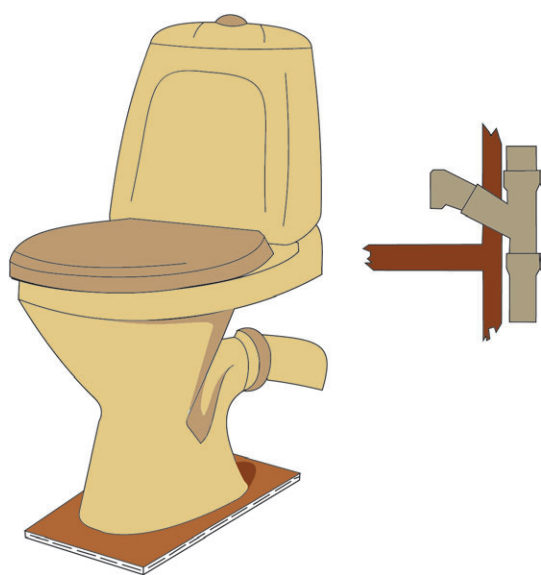
Рис. 7.13. Крепление унитаза к деревянной панели
