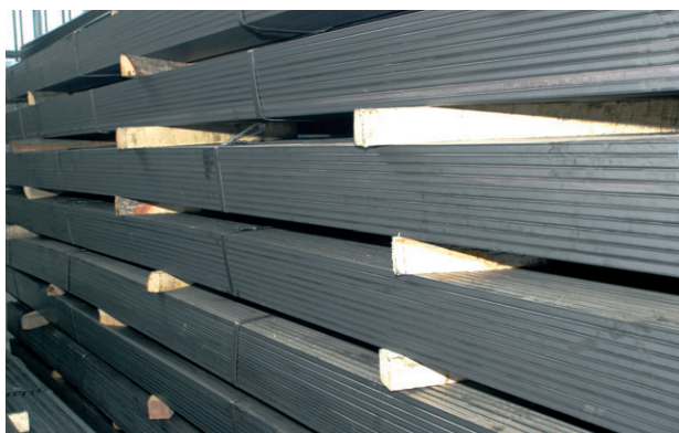
Рис. 10.10. Толстые стальные листы для изготовления печного оборудования
