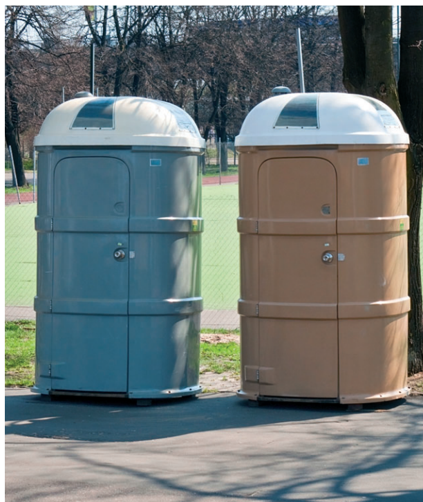
Рис. 7.20. Химический туалет. Конструкция включает специальный бак, где собираются нечистоты. Используется также отдельно стоящая выгребная яма. Специальные реагенты сдерживают процессы брожения и разложения, тем самым устраняя запахи
