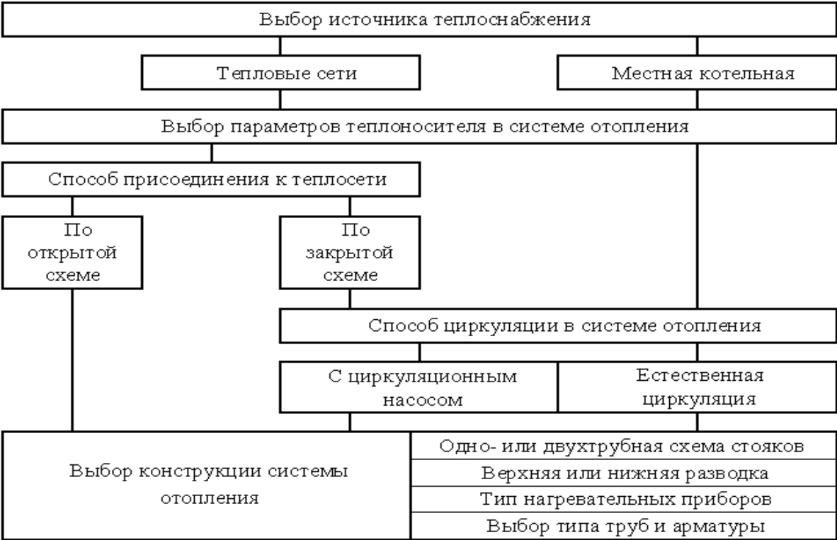
Рис. 4.1. Рекомендуемая последовательность выбора конструкции системы водяного отопления
