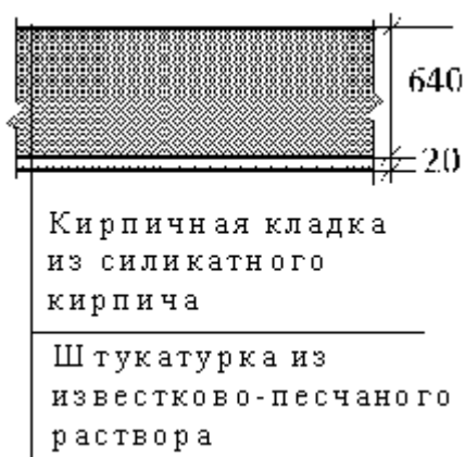
Рис. 3.4. Схема конструкции наружной стены
