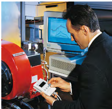
Блок управления и индикации
