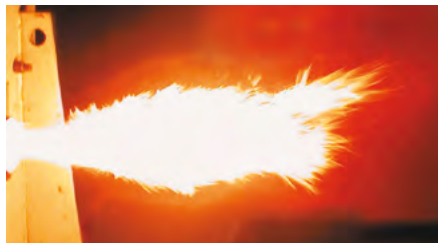
Форма пламени горелок стандартного исполнения (дизельная горелка L5Z на испытательном стенде)
