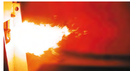
Форма пламени горелок исполнения SF (дизельная горелка L5Z-SF на испытательном стенде)
