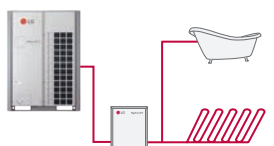
Горячая вода + лучистое отопление
