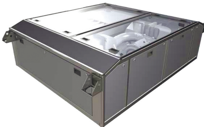
Рис. 26. Воздушная климатическая система (ВКС) для железнодорожных вагонов
