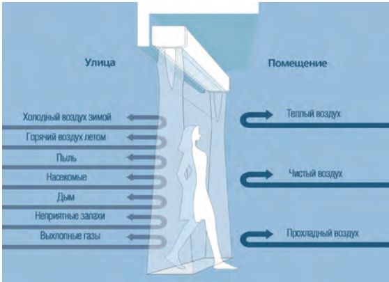
Принцип работы воздушной завесы
