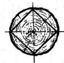
Рис. 67. Разметка бревна на четыре канта
