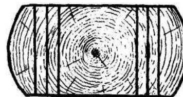
Рис. 62. Резка двухкантного бруса (вторая распиловка): 1 — брус; 2 — обрезная доска; 3 — трехкантный горбыль
