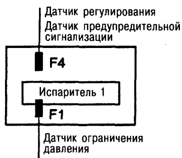
Рис. 4.77. Расположение чувствительных элементов датчиков относительно регулируемых контуров (охлаждаемых объектов) 1–3
