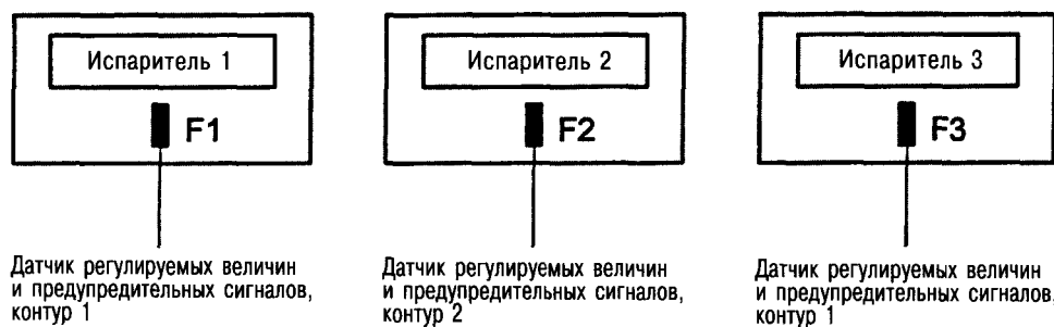
Рис. 4.77. Расположение чувствительных элементов датчиков относительно регулируемых контуров (охлаждаемых объектов) 1–3
