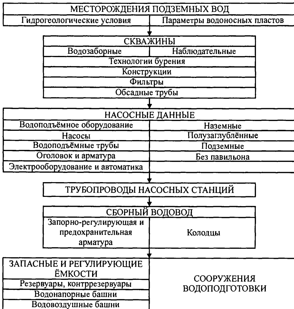
Рис. 8.1. Схема очередности проектирования объектов и элементов скважинного водозабора
