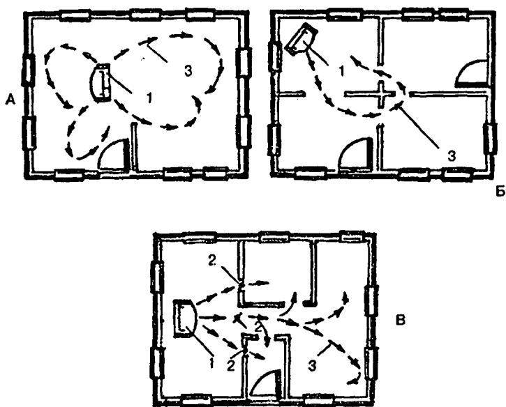
Рис. 83. Варианты размещения отопительных печей: А - в центре или с небольшим смещением от центра; Б - угловое размещение печи; В - пристенное размещение печи с наличием вентиляторов для создания тепловых потоков; 1 - печь; 2 - вентиляторы; 3 - потоки теплого воздуха
