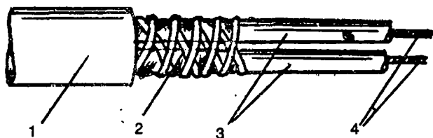
Рис. 79. Двужильный резистивный кабель: 1 - оболочка; 2 - медный экран; 3 - изоляция из термостойкого полимера; 4 - токонесущие проводники
