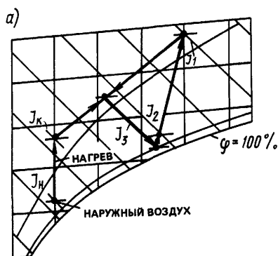
Рис. 15.7. Схемы обработки воздуха в системе, работающей с постоянным расходом наружного воздуха при применении первой и второй рециркуляции (а и б), и в системе, работающей без применения второй рециркуляции (а и в), при условии, что расход наружного воздуха больше или равен вычисленному по формуле (15.16)
