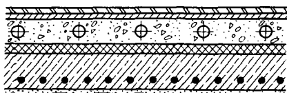
Рис. 6.5. Разрез греющего пола
