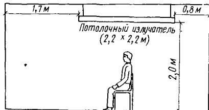
Рис. 17.17. Расположение системы потолочного лучистого отопления в экспериментах, проведенных Фангером, Банхиди, Олесеном и Лангкильде
