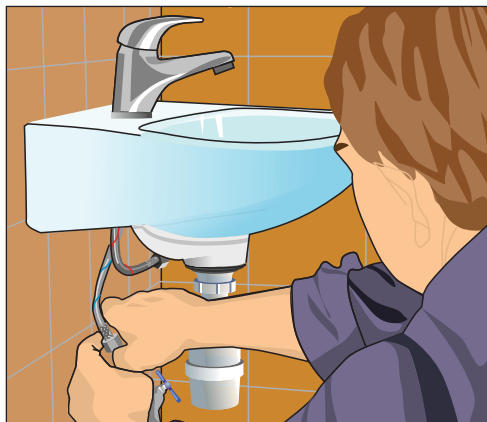
Рис. 10.30. Соединяем гибкую подводку с системой горячего и холодного водоснабжения
