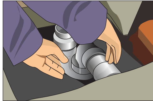
Рис. 10.179. Собираем и прикручиваем сифон
