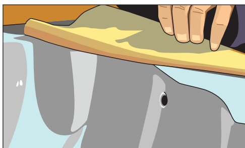
Рис. 11.9. Закрываем переливное отверстие полотенцем или заклеиваем скотчем
