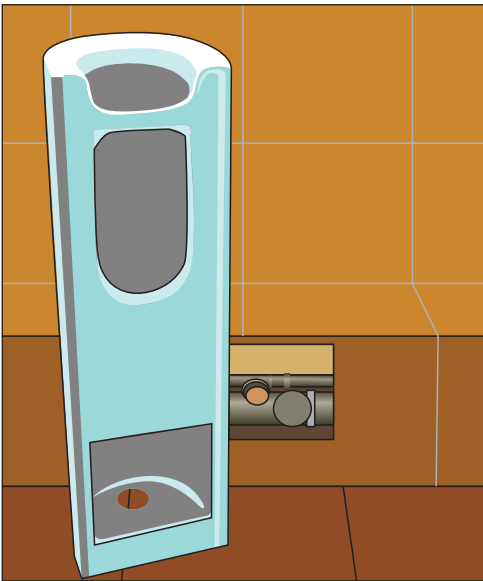
Рис. 10.65. С обратной стороны пьедестал имеет керамические перегородки
