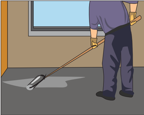
Рис. 12.4. Грунтование бетонного основания
