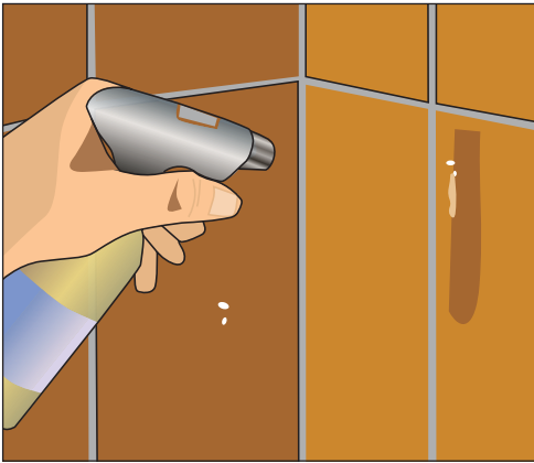
Рис. 1.39. Наносим фунгицидное средство на место замены герметика
