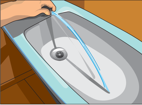
Рис. 10.152. Проверяем герметичность установки — включаем воду
