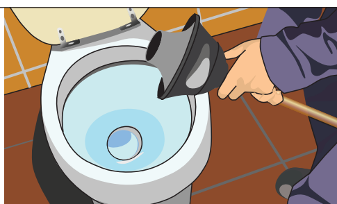
Рис. 11.11. Прокачиваем вантузом воздух вверх-вниз (слева), пока вода не уйдет вниз (справа)
