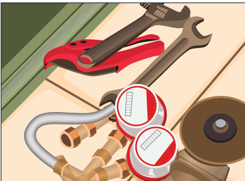
Рис. 6.3. Инструменты для монтажа счетчиков: фитинги, набор гаечных ключей, труборезы
