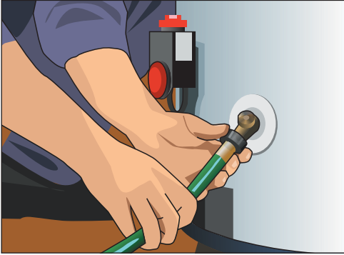
Рис. 10.300. С помощью гибкой подводки соединяем раковину и водонагреватель
