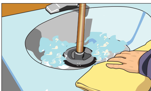
Рис. 11.11. Прокачиваем вантузом воздух вверх-вниз (слева), пока вода не уйдет вниз (справа)
