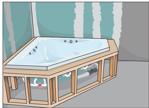
Рис. 10.191. Установка джакузи в деревянный каркас
