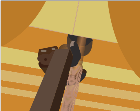
Рис. 10.23. Используем рычажный или разводной ключ, чтобы затянуть гайки потуже
