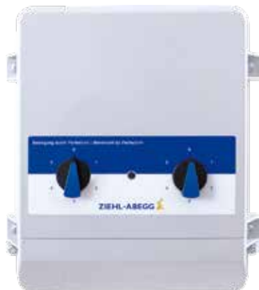
Трансформаторные регуляторы, 1-фазные с двумя 5-ступенчатыми переключателями, возможность выбора двух уставок скорости вращения с помощью внешних устройств
