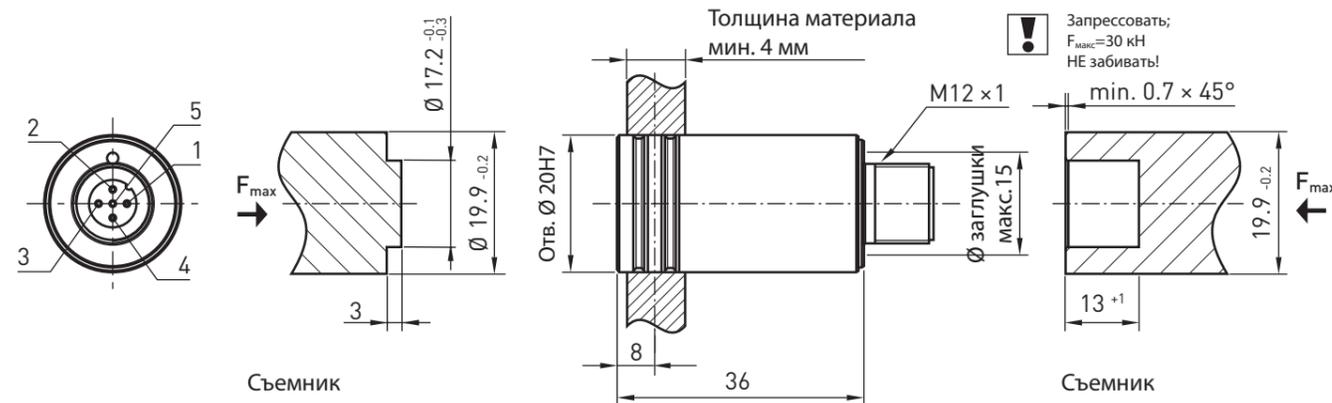
Монтажное положение тензодатчика
