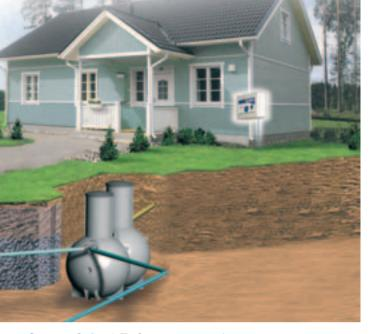
Система **Sako-3 Twin** – система инфильтрации предназначенная для очистки бытовых сточных вод от индивидуальных домов и дач. При помощи системы можно обрабатывать все бытовые сточные воды. Система состоит из двух сферических емкостей, распределителя потоков, находящегося внутри второй емкости и инфильтрационных труб.
