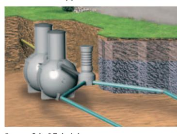
В системе **Sako-3 Twin de Luxe** распределитель потока заменен отдельным распределительным колодцем, позволяющим расположить поле фильтрации, где это необходимо. Инфильтрационные трубы в этом случае могут иметь разное направление. Это решение применяется в случае плохой фильтрующей способности почв или гористой местности.
