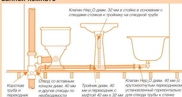
Рис. 10. Установка клапана Нер V O в типовой ванной комнате
