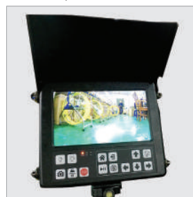
Блок управления DVR с водонепроницаемой панелью
