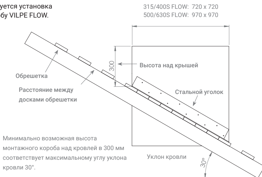
На рисунке сверху: монтажный короб FLOW, установленный на скатную кровлю. Монтажный короб готов к обшивке и установке кровельного материала.
