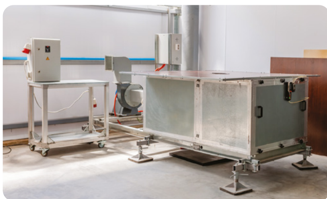
Стенд для определения объема протечки клапана
