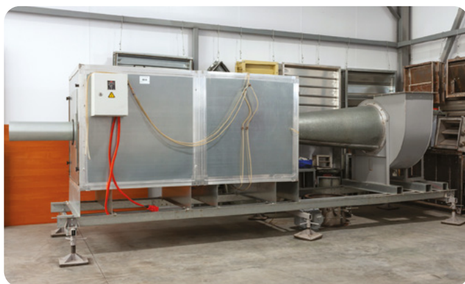
Стенд для определения аэродинамического сопротивления оборудования
