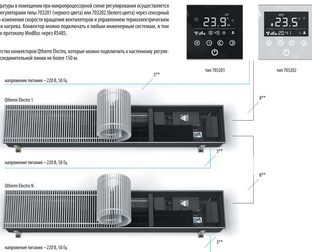
\* Для соединительных линий применяется восьмижильный, экранированный кабель UTP 4x2x0,4.
