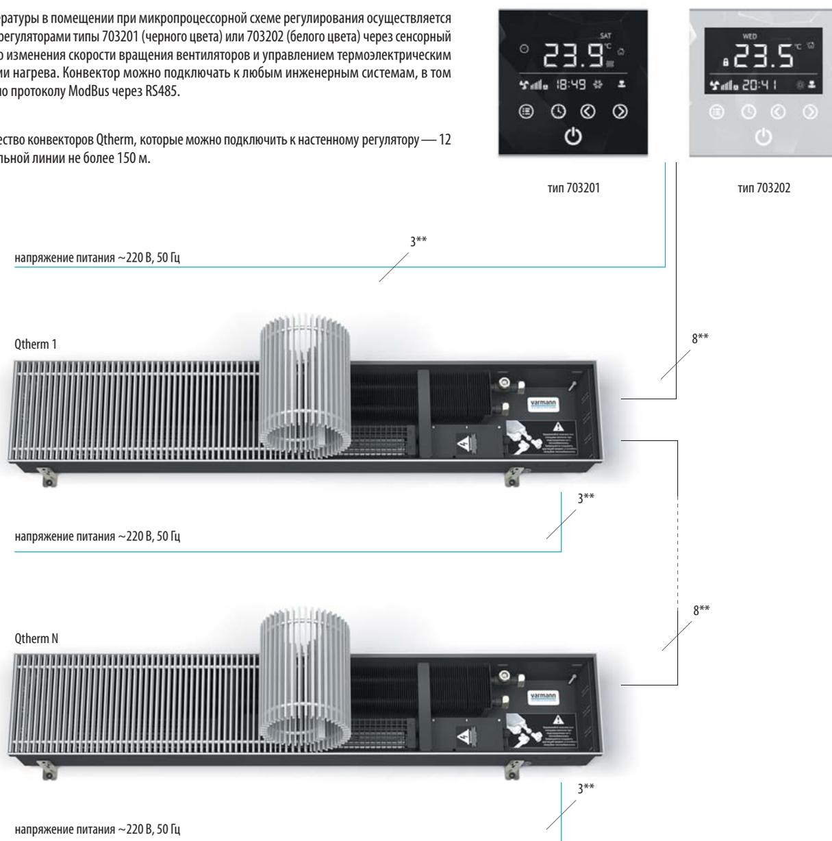
\* Для соединительных линий применяется восьмижильный, экранированный кабель UTP 4x2x0,4.
