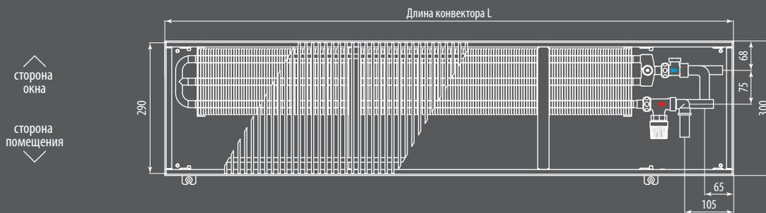
Вид сверху конвектора Ntherm 300.90 с роликовой решеткой с U-образным бортом
