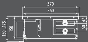
Разрез Ntherm Air 370.150 с U-образным бортом
