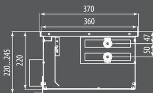
Разрез Ntherm Air 370.220 с U-образным бортом
